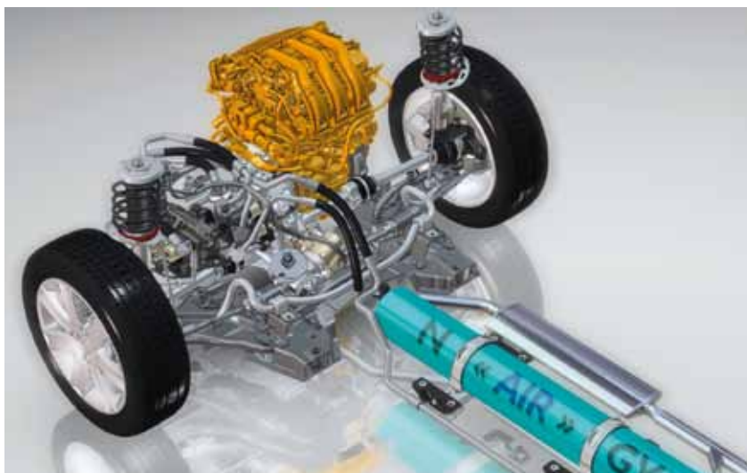
Chaîne de traction HYbrid Air, PSA
