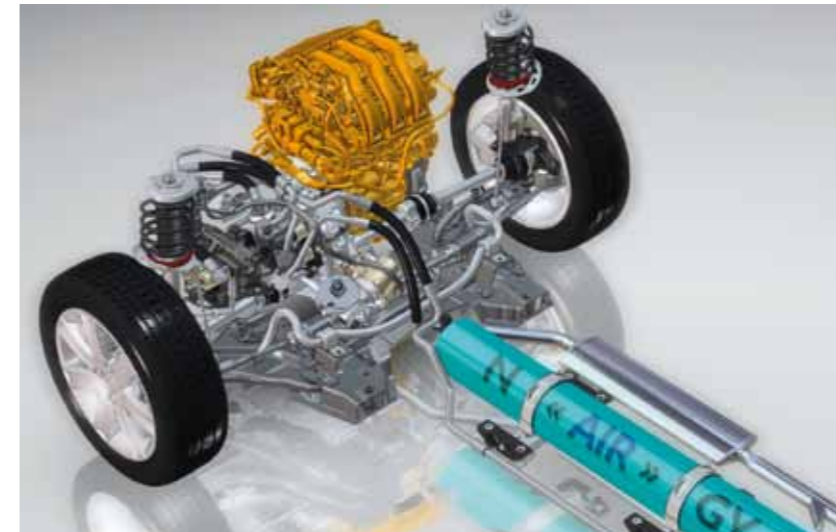
Chaîne de traction HYbrid Air, PSA
